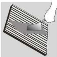
La primera capa de adhesivo debe ser delgada y su aplicación debe realizarse con el lado plano de la llana, luego proceder a "peinar" el producto con el lado dentado de la misma.
